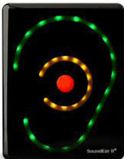
Le dispositif « Soundear » mesure en continu les niveaux de bruit dans la pièce et assure une surveillance, en temps réel, de l'intensité sonore. « Soundear » est un outil de prévention efficace pour lutter contre les troubles dus aux nuisances sonores pouvant porter atteinte au bien-être des collaborateurs dans notre *open space* :
